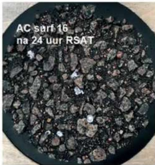
Fotoserie 1 Details boorkernen van AC16, DGD en SMA (met lichte/matige rafeling)
