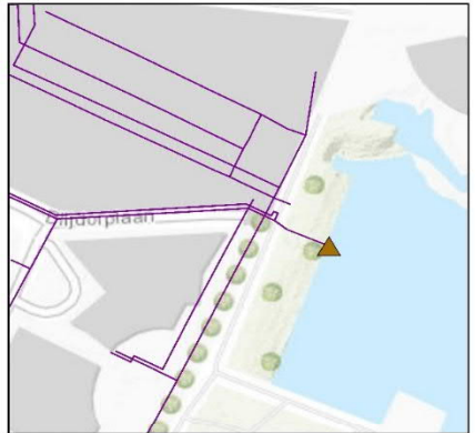
Dichtsbijzjnde riooloverstort westelijke kant
